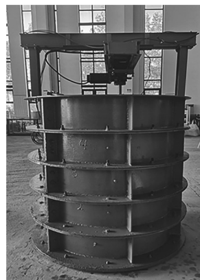
图2 桩侧挤密注浆模型装置
