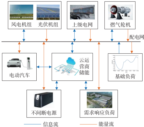
图1 含云储能的配电网多主体交互结构
