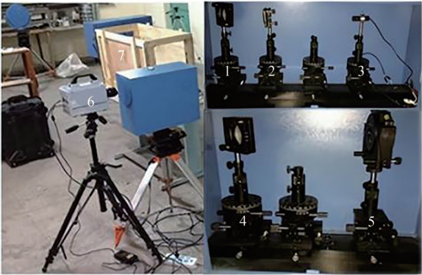
1. 平面镜1; 2. 扩束镜; 3. 激光器; 4. 平面镜2; 5. 刀口; 6. 高速相机; 7. 防护木箱。
