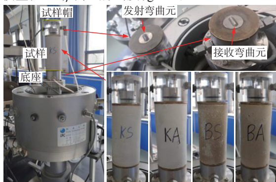
图5 GDS-BES弯曲元测试系统
