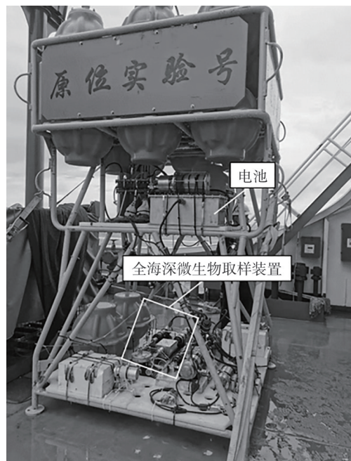
图 12 取样装置布置于万米着陆器
