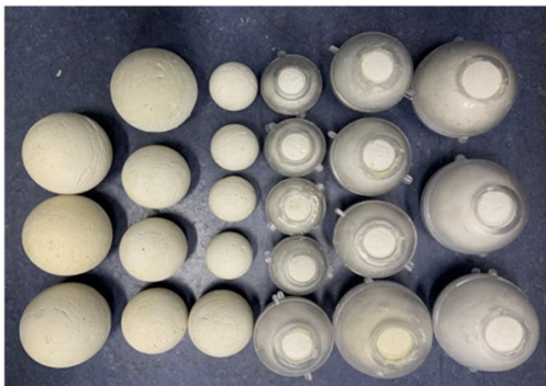
图 2 法向碰撞试验落石试样和模具
