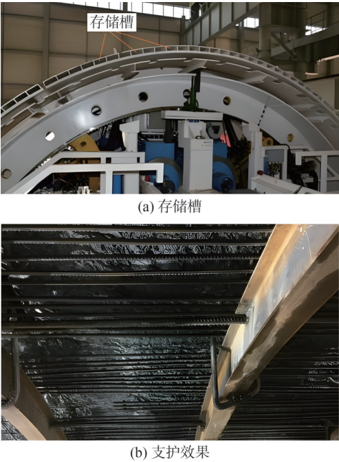
图 18 钢筋排存储槽及支护效果
