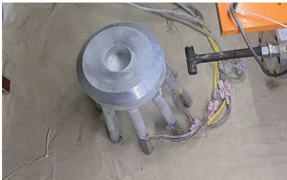
图2 高桩承台基础离心机试验现场
