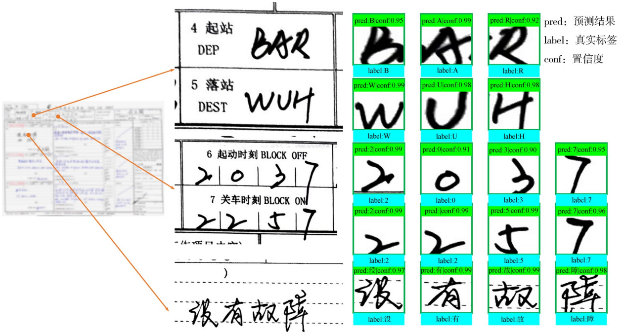
图 10 飞机地面维护工卡手写识别测试
