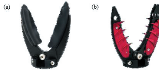
图 2 (a) 海洋采集用软夹; (b) 搜救打捞用特殊回收钳
