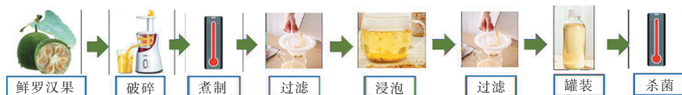
图 1 实验室制备罗汉果复合饮料工艺流程图
