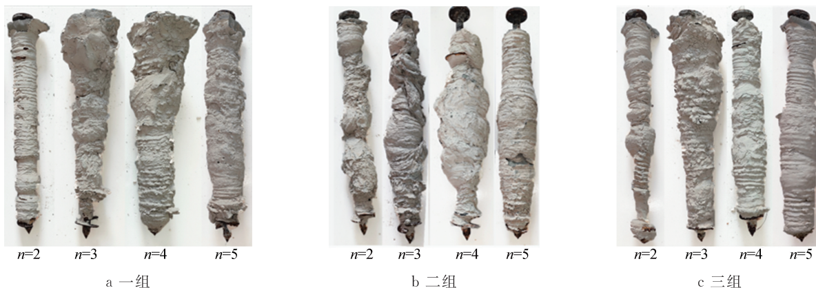
图 8 HSCM 桩实际成桩效果 Fig. 8 Actual pile forming effect of HSCM pile
