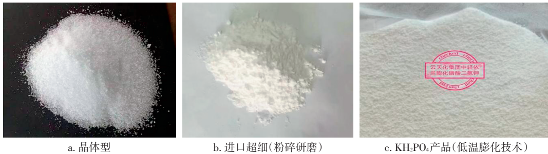
图1 不同形态KH 2 PO 4 的外观对比
