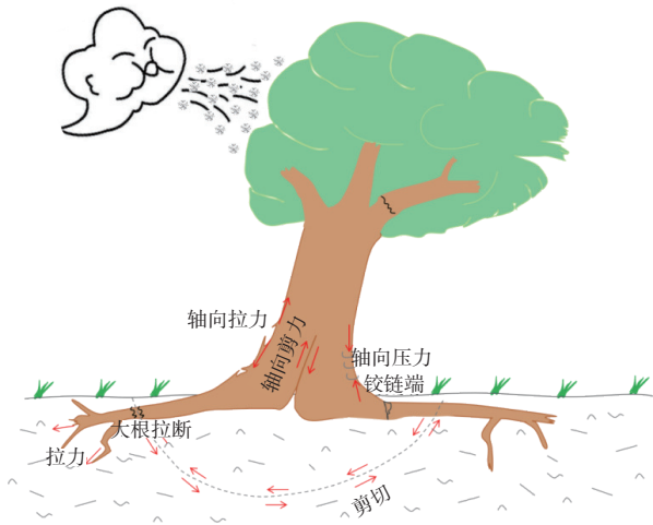
图 10 风力雪载下大树可能发生的几种破坏方式示意图
