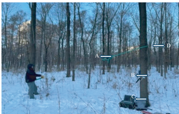
图1 树木拉伸试验现场图 Fig. 1 Field test of tree tensile
