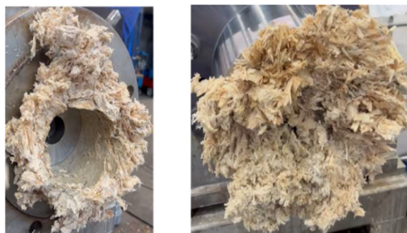
图5 安德里茨MSD撕裂机对木片的撕裂效果
